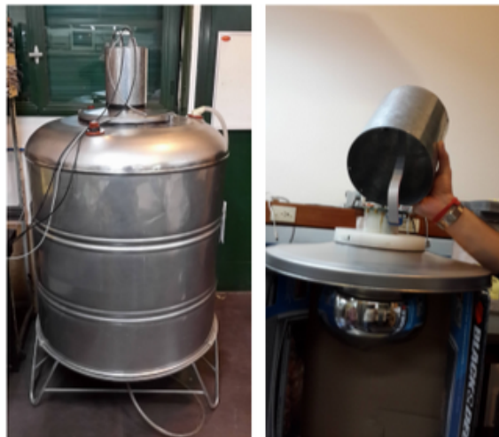
Figura 4.2: Fotos del tanque correspondiente al WCD. En la parte superior de este se observa el soporte que contiene el PMT.
