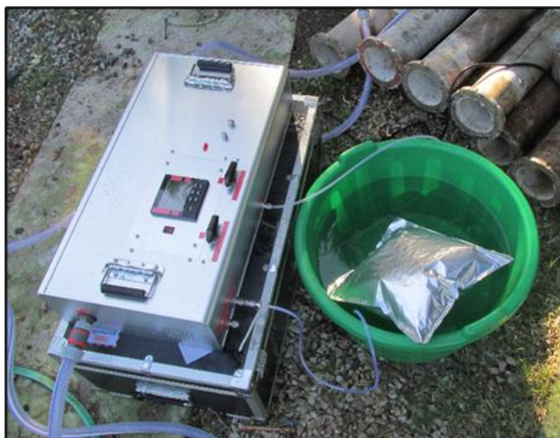
Figura 4.3. Muestreo de aire atmosférico disuelto en agua en INTA Balcarce, marzo de 2022. a) El agua bombeada del pozo (A) circula a través del equipo extractor de gases (B), donde un contactor de membrana separa la fase gaseosa, la cual se acumula en la bolsa de muestreo (C), sumergida en agua para descartar pérdidas de aire. b) Equipo extractor de gases a la izquierda y bolsa de muestreo Supel™-Inert Multi-Layer Foil de 10 litros a la derecha.
