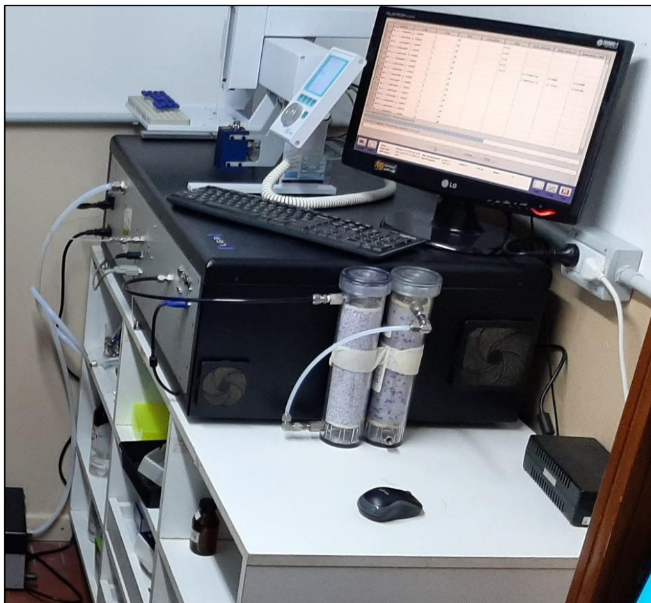
Figura 4.7. Espectroscopio láser LGR LWIA-45-EP del laboratorio de Hidrología Isotópica de la UNMdP, utilizado para medir el contenido de isótopos estables en agua. Mayo del 2022.
