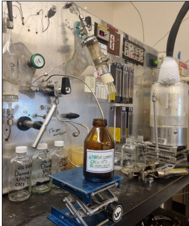
Figura 4.6. Medición de CFCs en muestra de 125 ml de agua tomada de un piezómetro de Lobería en febrero de 2024. Laboratorio de Trazadores Ambientales de la Universidad de Utah, EE. UU. Abril del 2024.
