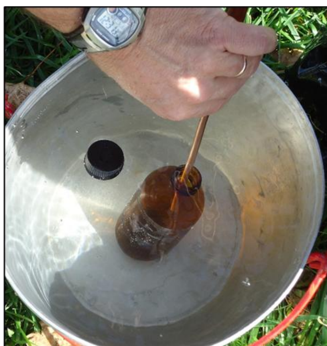
Figura 4.5. a) Toma de muestra de SF 6 de pozo INTA Balcarce durante la campaña de marzo de 2022. b) toma de muestra de CFCs sumergida en agua de pozo Chacra Miramar durante la campaña de febrero de 2024.
