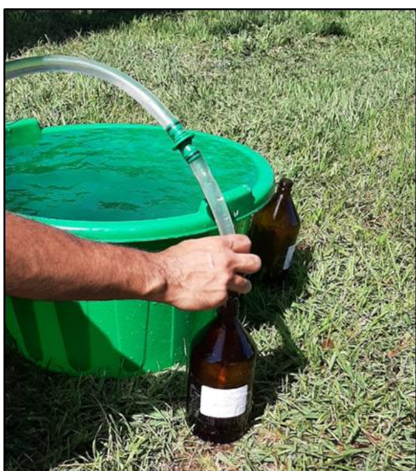
Figura 4.5. a) Toma de muestra de SF 6 de pozo INTA Balcarce durante la campaña de marzo de 2022. b) toma de muestra de CFCs sumergida en agua de pozo Chacra Miramar durante la campaña de febrero de 2024.
