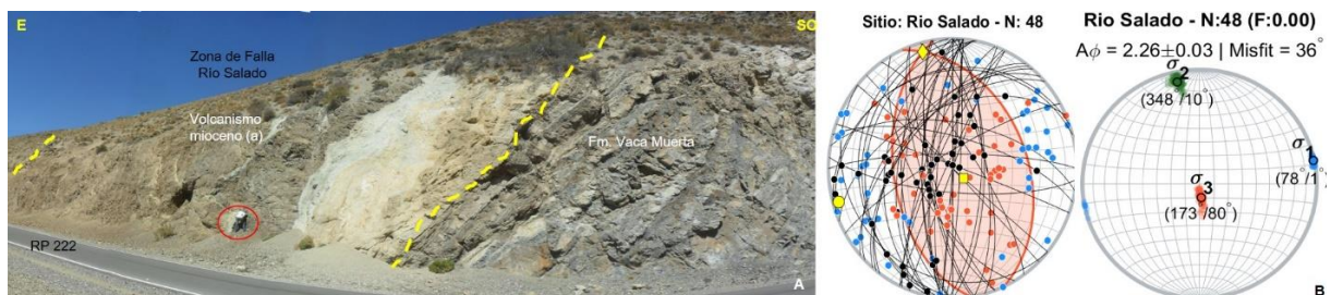
Figura 5.16. a. Vista de la zona de falla de la falla Río Salado en el margen sur del río homónimo. b. Representación estereográfica de planos de deslizamiento. El sentido de movimiento de cada plano se determinó a partir de la presencia de slickensides y Riedel. La flecha indica el movimiento del bloque colgante. c. Solución del plano de falla y ejes de deformación mínimo, medio y máximo (1, 2 y 3, respectivamente) obtenidos a partir de los ejes P (azul) y T (rojo).
