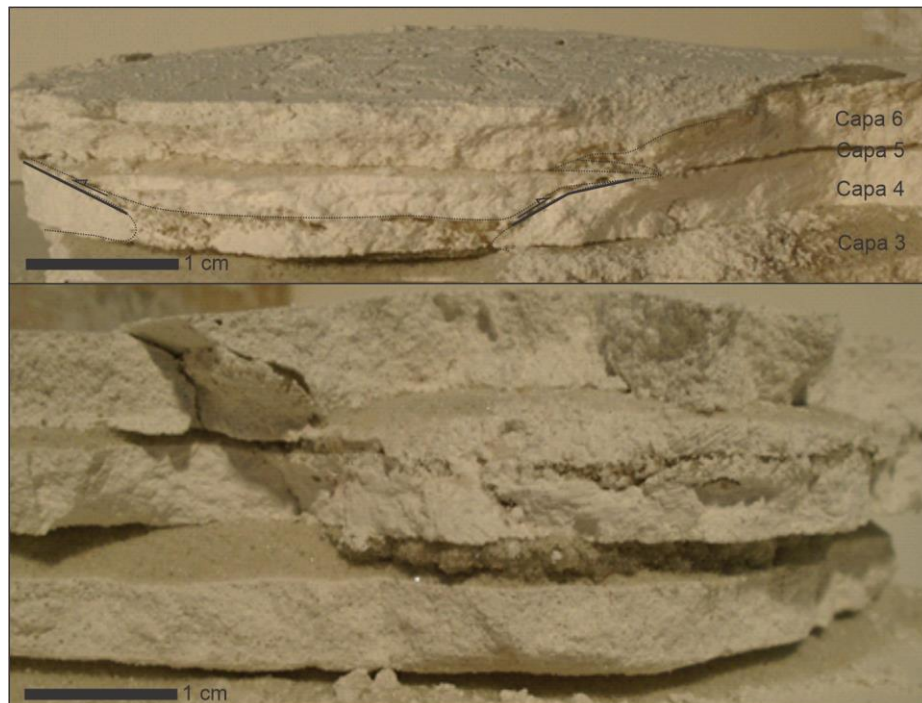
Figura 8.8. a. Vista lateral desde el margen superior (capas 3 a 6. b. vista lateral desde margen inferior. Obsérvese que en las capas menos cohesivas adopta formas más potentes mientras que en capas de mayor cohesión se restringe a las zonas de apertura tensional o cizalla.
