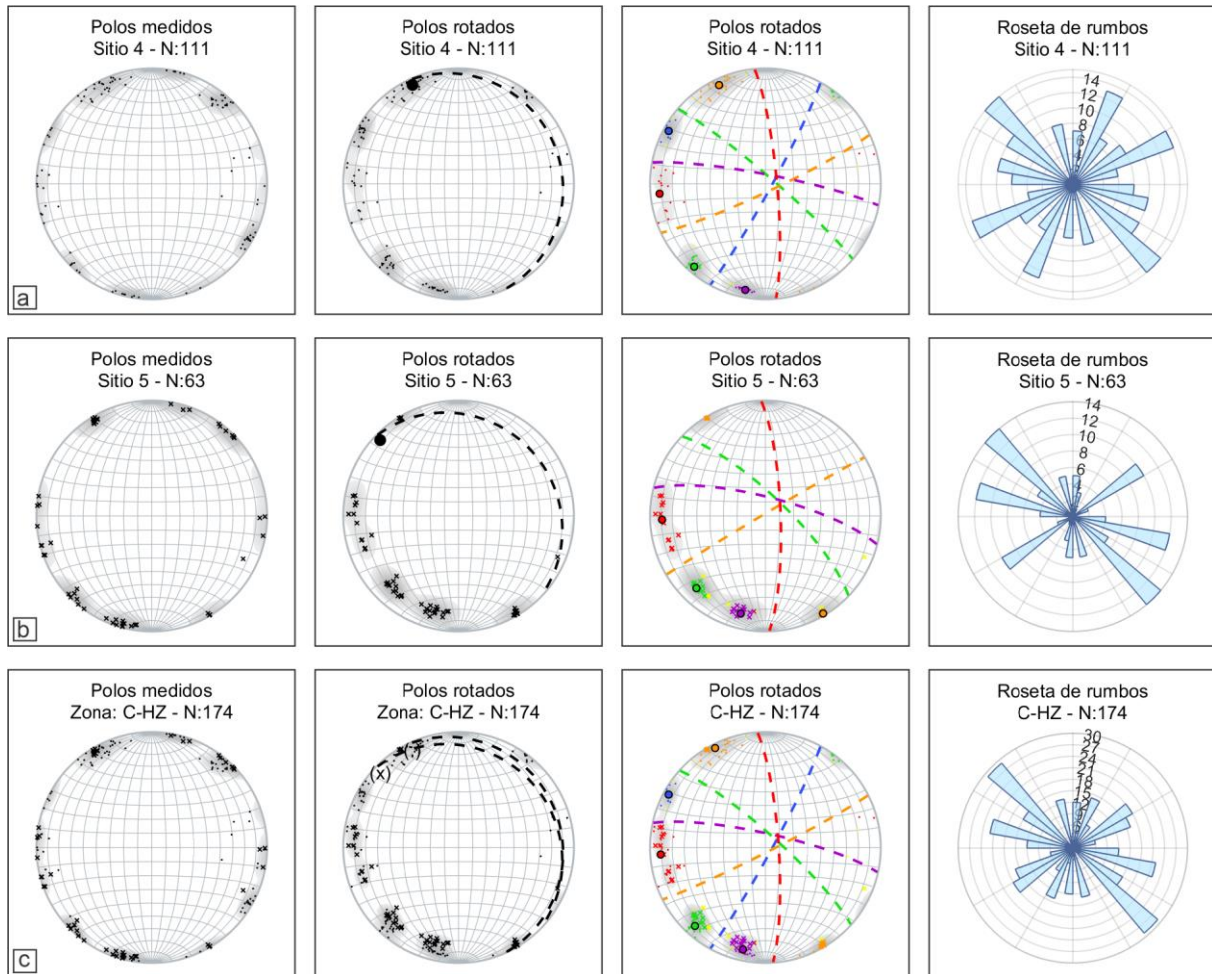
Figura 5.7. Resultados de las mediciones de fracturas en en los Grupos Cuyo y Lotena en la zona de charnela del sector sur del braquianticinal Los Blancos (sitios 4 y 5). Se indican: Proyección del hemisferio inferior de igual área con los contornos de densidades de los polos de fracturas medidos; Contornos de densidad y polos luego de la corrección estructural. El eje de rotación se indica con el círculo máximo en línea punteada; Polos y círculos máximos que corresponden a los planos medios de cada familia identificada. a. Fracturas medidas en el sitio 4, con planos medios de los patrones determinados: NO, NNE, NE, ONO y N. b. Fracturas medidas en el sitio 5, con planos medios de los patrones determinados: NO, ONO, NE y N c. Total de fracturas medidas en la zona de charnela.
