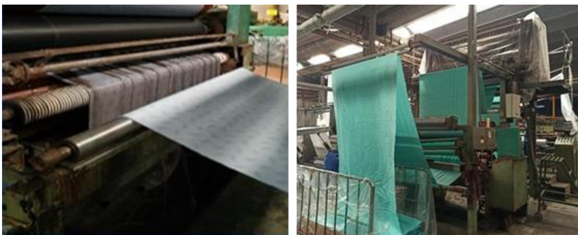
Figura 7.2. Proceso de impregnación de las telas de algodón-poliéster
