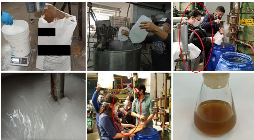
Figura 7.1. Proceso de producción de las soluciones activas de plata y cobre.
