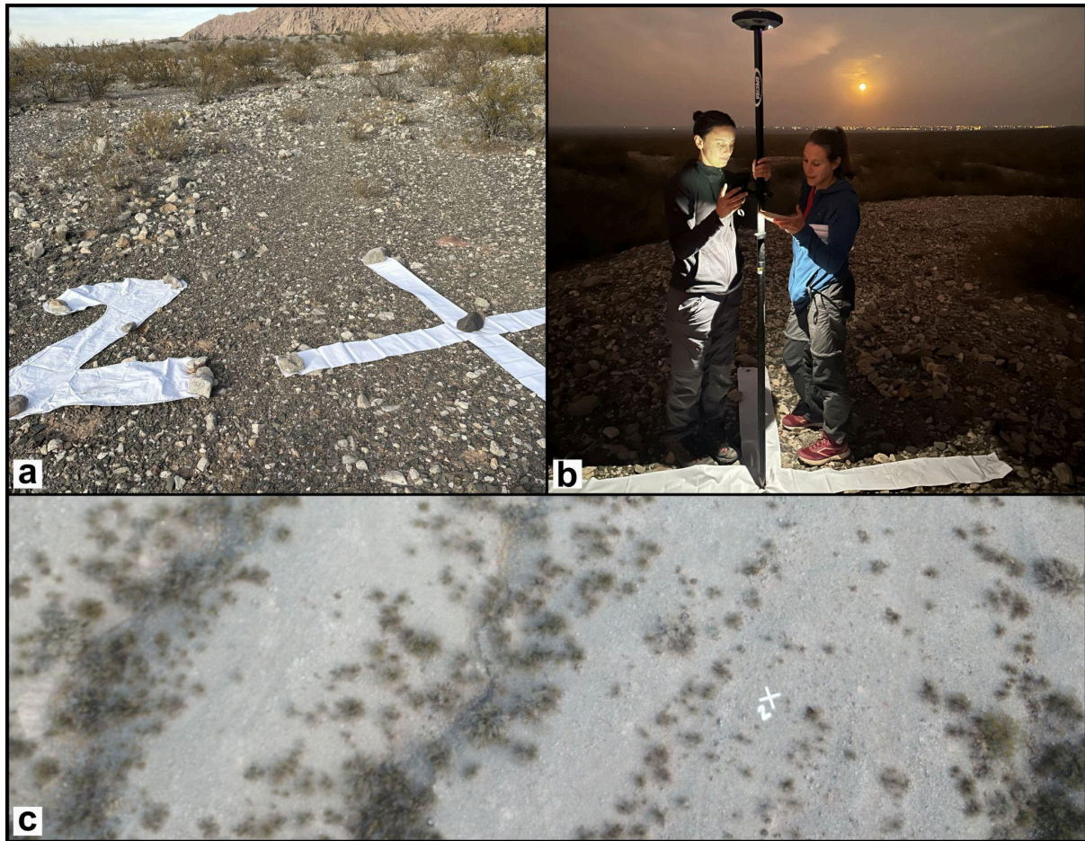
Figura 2.4: Puntos de control del terreno. (a) Marcadores empleados. Se utilizaron cruces y números de tela cuerina, cada uno con un tamaño aproximado de 2m. (b) Medición con dGPS de los puntos de control para asegurar una precisión milimétrica. (c) Marcadores reconocidos desde VANT a 100m de altura.
