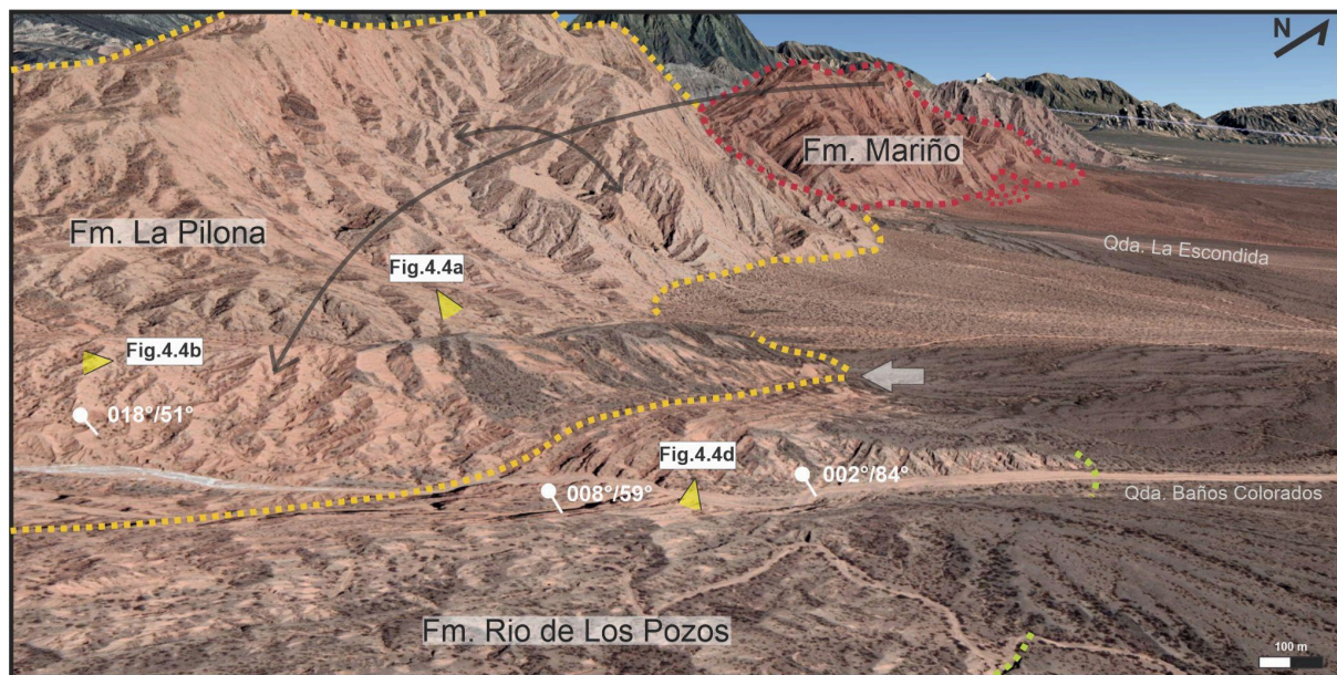
Figura 4.3: Imagen satelital (Google Earth) donde se indica con una flecha el quiebre marcado en la topografía que coincide con el inicio de la Formación Río de Los Pozos, suprayacente a la Formación La Pilona (línea punteada amarilla). Con línea punteada verde se muestra el contorno de la Formación Río de los Pozos. Se observa el cierre anticlinal Baños Colorados cuyo eje se hunde hacia el sur de la quebrada y que caracteriza el sector sur de la Sierra de Las Higueras-Las Peñas, donde los estratos inclinan al este-sureste. Exageración vertical del relieve (x2).
