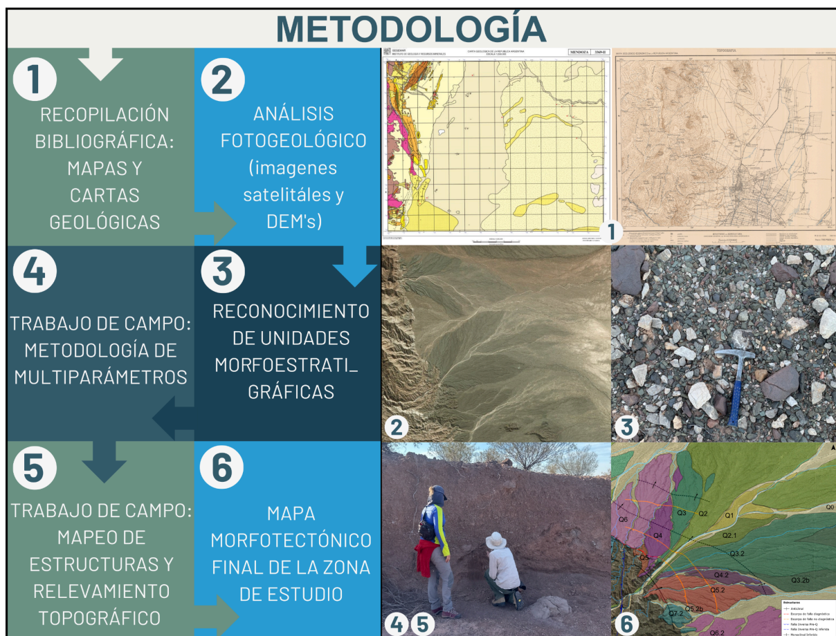
Figura 2.1: Síntesis de la metodología utilizada para la elaboración de un mapa morfotectónico de detalle, orientado a caracterizar la tectónica cuaternaria en la zona de estudio. Se presentan seis pasos numerados, acompañados de imágenes representativas de cada etapa del proceso.
