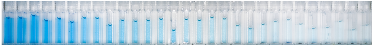
Figura 4.2.1.4: Fotografía de las alícuotas tomadas durante el tratamiento de una solución de 10 ppm de azul de metileno en agua empleando el RTA 2 con un solo sistema de electrodos DBD.
