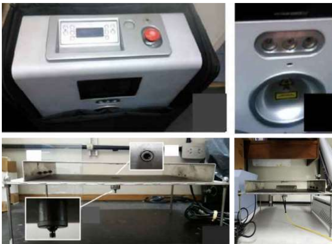
Figura 3: Fuente de luz NIR para TFT: láser 980 nm
