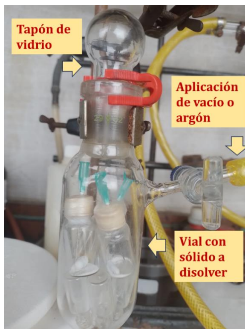
Figura 2.2 Tubo de Schlenk con viales adentro, que contienen los sólidos a disolver.
