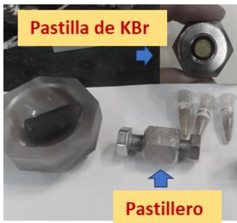
Figura 2.11 Armado de pastilla de KBr para espectroscopía FTIR de sólidos.
