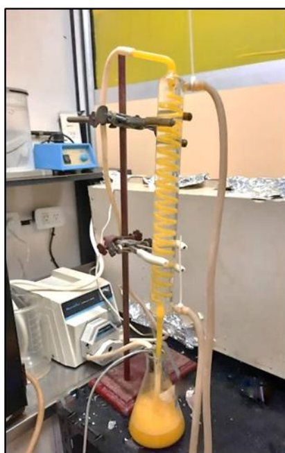
Figura 3.6. Tratamiento térmico ( 80^\circ\text{C} - 6 min) de jugo de naranja en coil de vidrio conectado a baño termostático.
