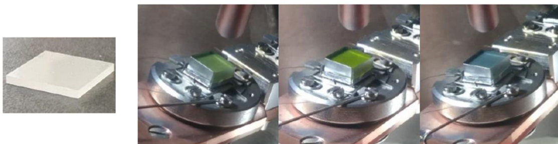
Figura 10. De izquierda a derecha: monocristal de rutilo \text{TiO}_2 (110) nuevo y luego de ser sometido a ciclos de sputtering – annealing hasta alcanzar finalmente su color azul claro característico. 49
