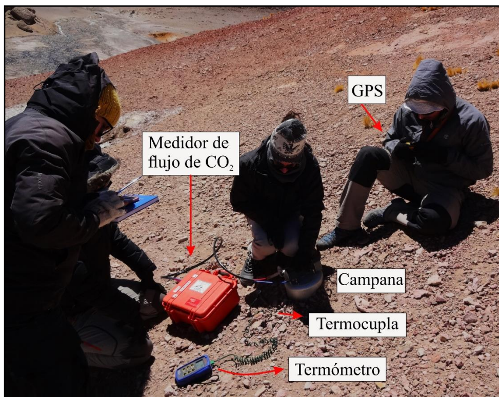
Figura 4.8. Fotografía del equipamiento para medir el CO 2 difuso y la temperatura del suelo.
