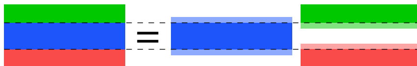
Figura 4.3: (Izquierda) Esquema de la descomposición del dominio (caso 2D) indicando un dominio central (azul) junto con sus 2 dominios adyacentes (verde y rojo). (Derecha) Disgregado de los dominios por separado, indicando sus regiones fantasma superpuestas en tono más claro.
