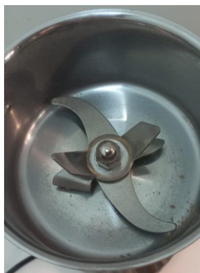
Figura 2.3. Equipos de reducción de tamaño. (a) Chipeadora (Potencia: 2500W). (b) Molino de hélice (Potencia: 850W; velocidad: 2800rpm; distribución de tamaños: 30-300mesh).
