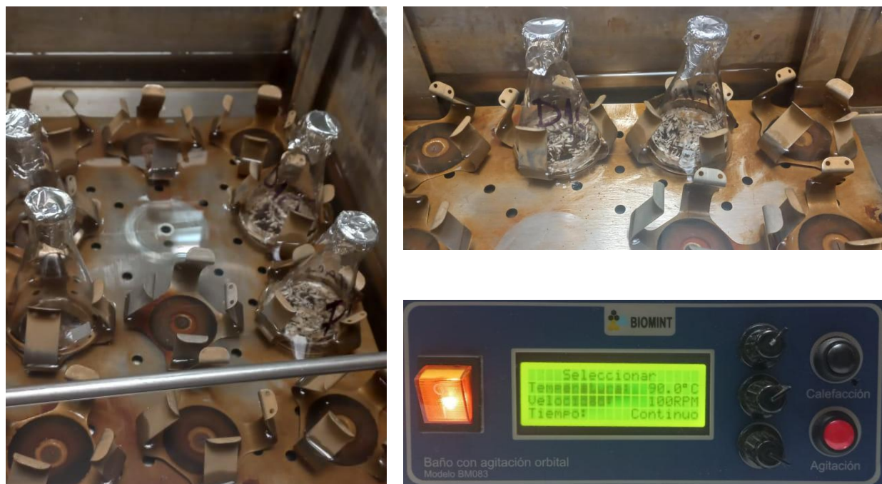
Figura 2.4. Baño termostatzado con agitación orbital donde se realizaron las hidrólisis ácido-oxidativas.
