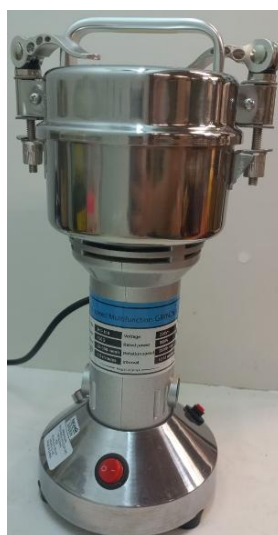
Figura 2.3. Equipos de reducción de tamaño. (a) Chipeadora (Potencia: 2500W). (b) Molino de hélice (Potencia: 850W; velocidad: 2800rpm; distribución de tamaños: 30-300mesh).
