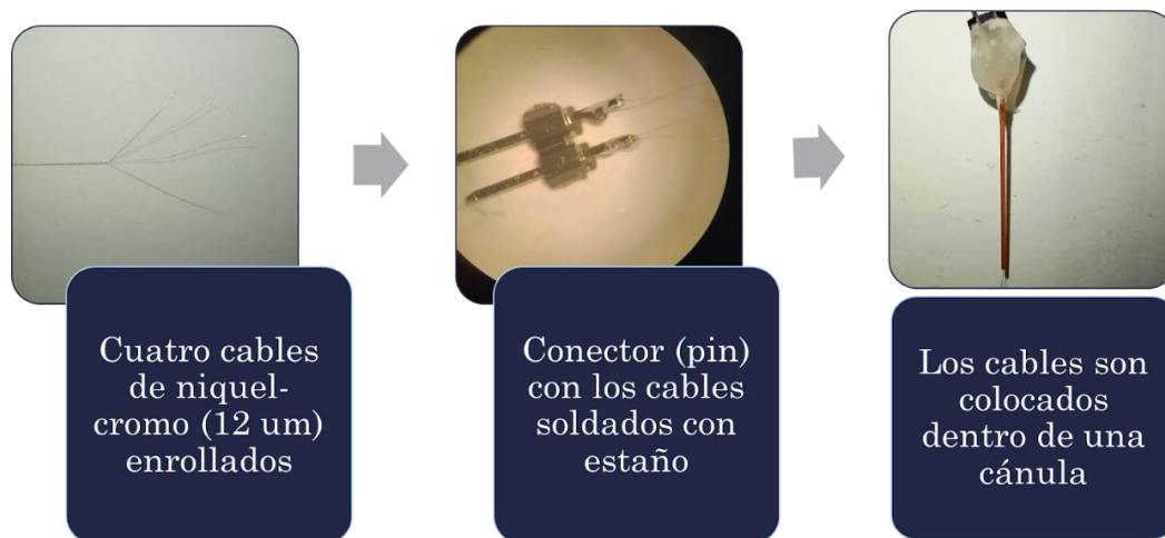
Figura 4.7 – Procedimiento para el armado de electrodos.
