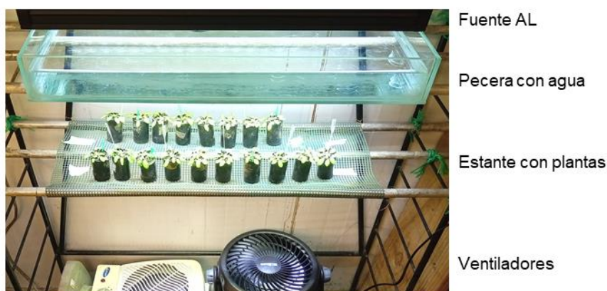
Figura 4.1. Fotografía del sistema de AL. Se puede ver la fuente de luz LED, la pecera con agua colocada debajo, el estante grillado con las plantas y ventiladores por debajo.
