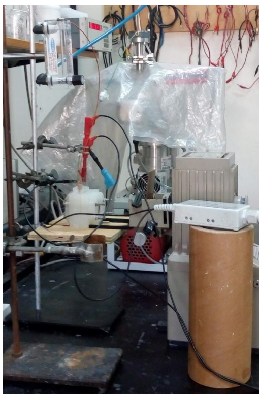
Figura 6.7 Arreglo experimental utilizando la lámpara de xenón, la PEC y el DEMS.
