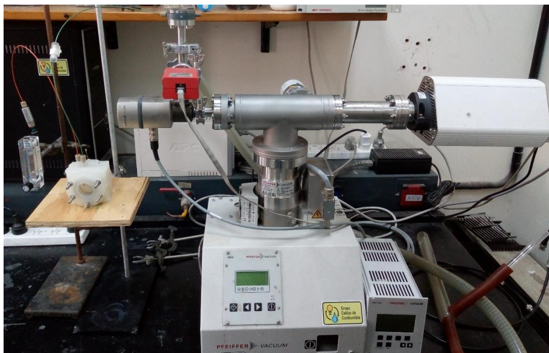
Figura 6.1 Equipo utilizado para la detección del hidrógeno. A la izquierda la celda fotoelectroquímica, a la derecha el espectrómetro de masas del DEMS.
