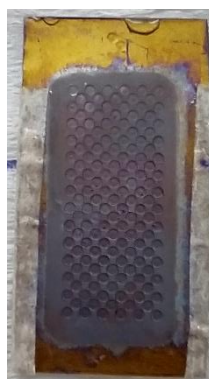
Figura 4.27 Fotografía de los NTs crecidos sobre la lámina de Ti con el grabado realizadas con el CNC
