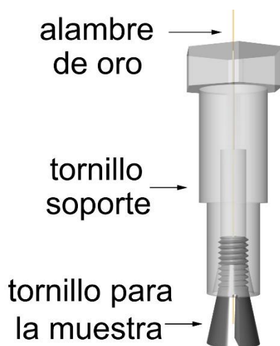
Figura 3.3 Esquema del tornillo sujetador de muestras
