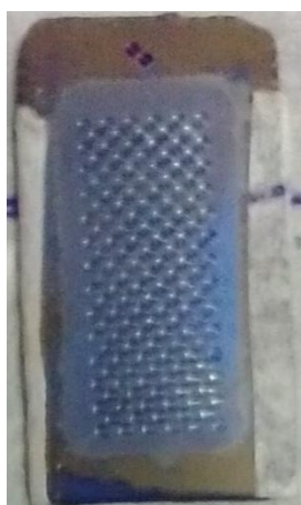
Figura 5.26 Fotografía de la lámina de Ti con NTs luego de la electroreducción a -3\text{ V} con región sin NTs tras su desprendimiento.
