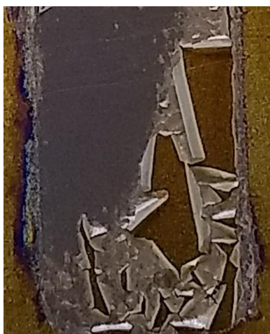
Figura 4.33 Fotografía de una lámina de Ti posterior al tratamiento térmico, para una muestra enjuagada con agua luego de la anodización
