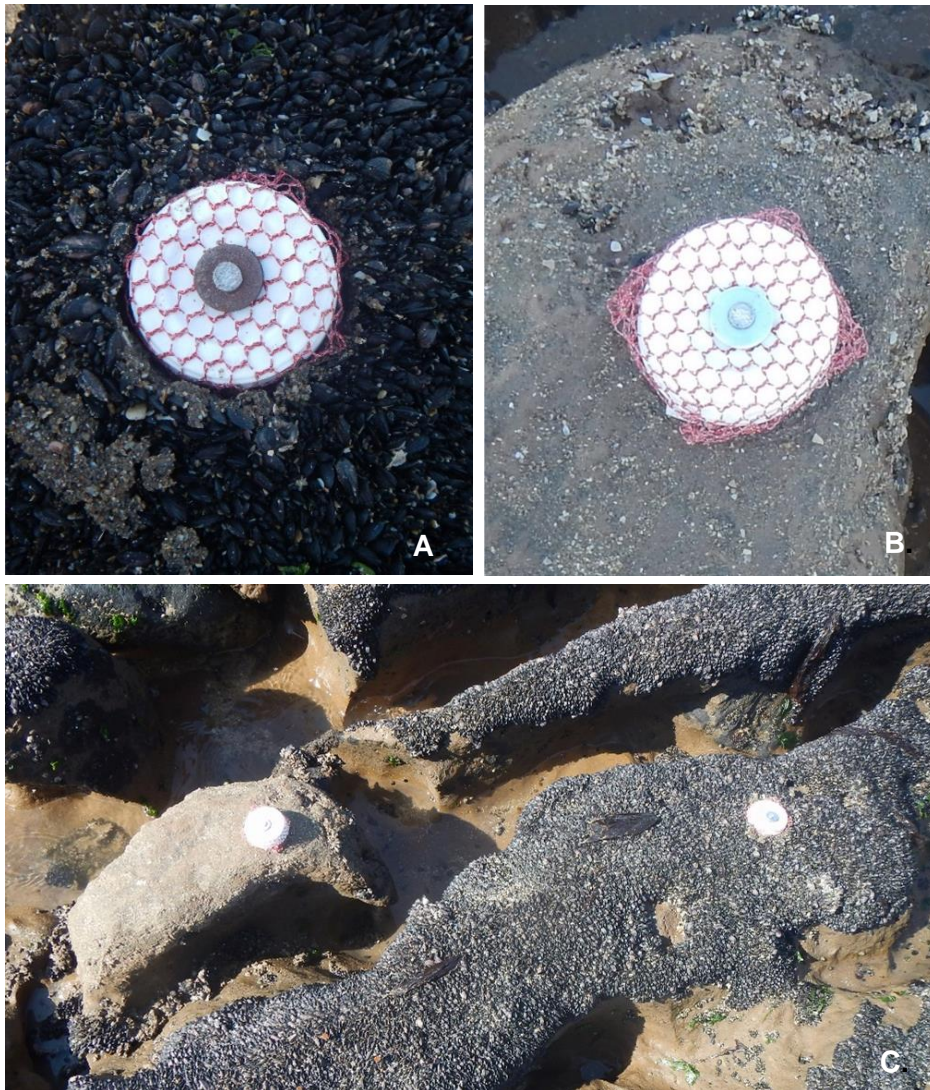
FIGURA 1.4. | Medición de la tasa de flujo de agua y abrasión. A. Disco de yeso en el banco control (con cobertura de mejillines). B. Disco de yeso en el banco con exclusión de mejillines. C. Vista conjunta de disco de yeso en el banco con exclusión y en el banco control.
