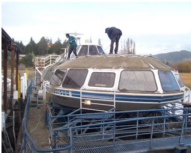
Figura 3.14. Remoción de la ceniza acumulada en las cubiertas de los catamaranes de Pto. Pañuelo, con una combinación de métodos secos y húmedos.
