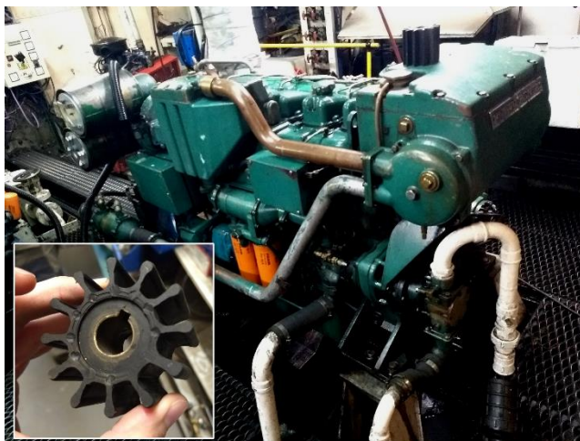
Figura 3.7. Ejemplo de un motor diésel marino en el barco Modesta Victoria , y detalle de un rotor de goma interno (intacto) del sistema de refrigeración del motor, erosionados por el efecto abrasivo de la ceniza volcánica ingerida por el sistema.
