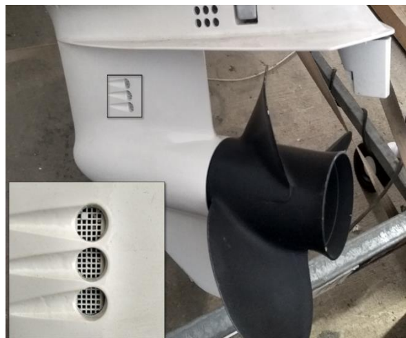
Figura 3.5. Fragmentos pumíceos atascados en la toma de agua de mar del fueraborda Tsunami tras una salida de campo en el noroeste del Lago Nahuel Huapi en octubre de 2021, una década después de la erupción del Cordón Caulle.
