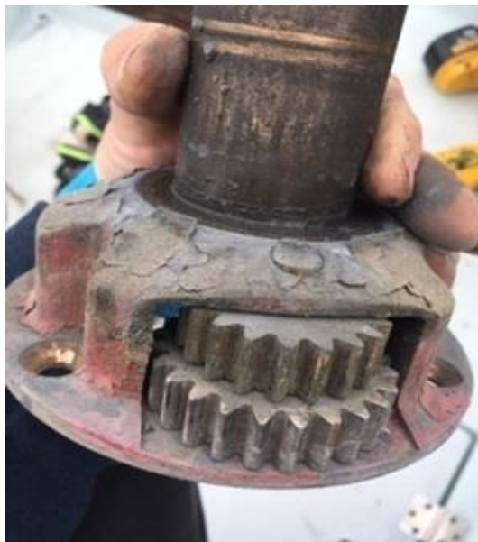
Figura 3.2. Ejemplo de delaminación de metales en componentes mecánicos de un motovelero del Club Náutico de Bariloche, a causa del daño corrosivo provocado por la ceniza volcánica.
