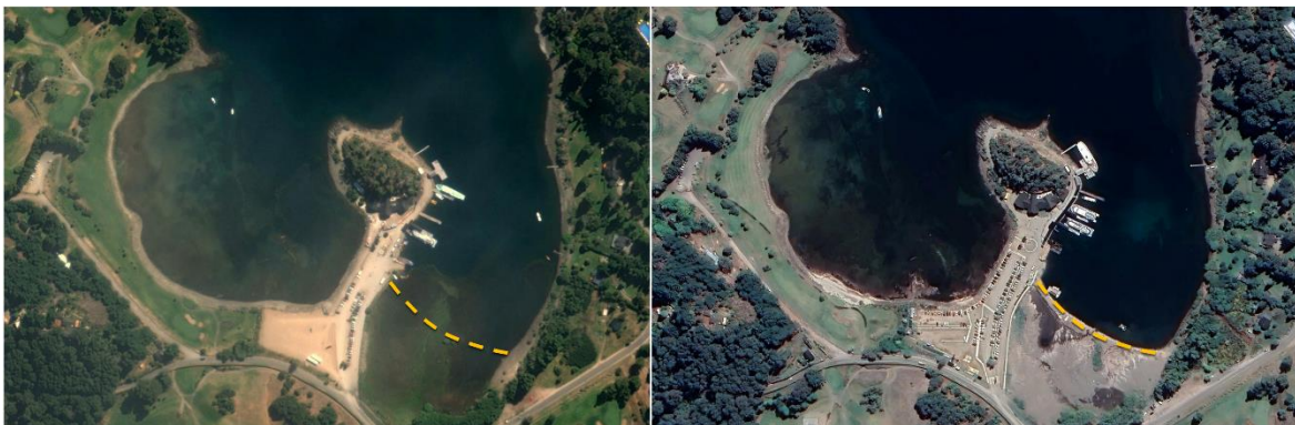
Figura 3.11. Vista aérea de Pto. Pañuelo antes (febrero de 2011) y diez años después (noviembre de 2021) de la erupción del Cordón Caulle de 2011-2012. La línea discontinua señala la ubicación del muro de gaviones construido para intentar contener el material piroclástico refulado de la bahía.
