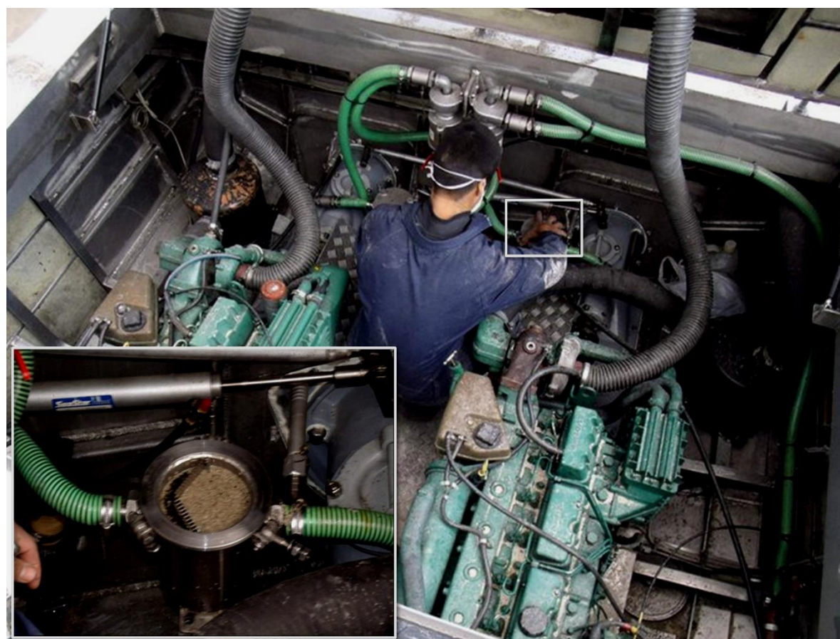
Figura 3.6. Limpieza de los filtros del sistema de refrigeración del motor marítimo, obstruidos con material pumíceo, en un buque de pasajeros de primera.
