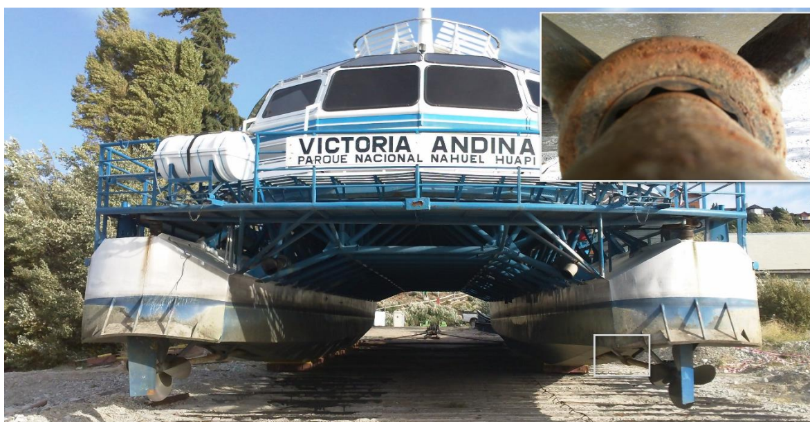
Figura 3.8. Detalle de los bujes helicoidales de goma en los ejes de cola del sistema de transmisión de una embarcación, corroídos por efecto de la ceniza volcánica en el agua.
