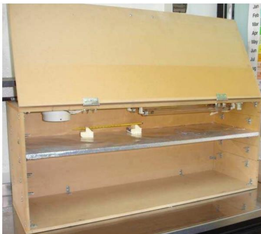
Figura 11. Cabina de luz UV utilizada para la aplicación de los tratamientos de fotólisis.
