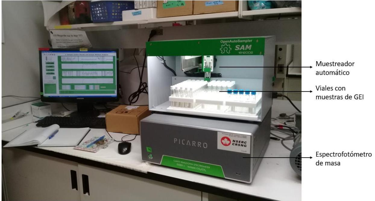
Figura 1.3. Medición de las concentraciones de GEI de las muestras obtenidas a campo, utilizando un muestreador automático y un espectrofotómetro de masa.
