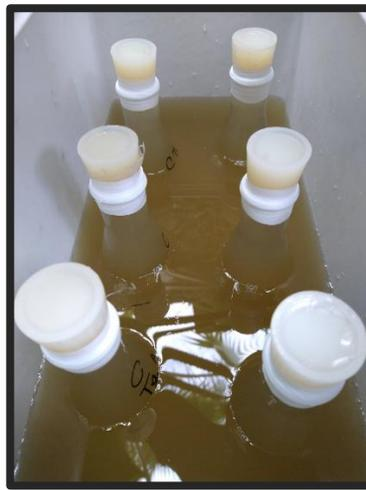
Figura 3.3. Incubación de los erlenmeyers dentro de la conservadora. Cada uno de ellos contenía agua de la laguna o de los mesocosmos y estaba cerrado con un tapón de silicona y cinta teflón para evitar el intercambio de GEI con el aire atmosférico.
