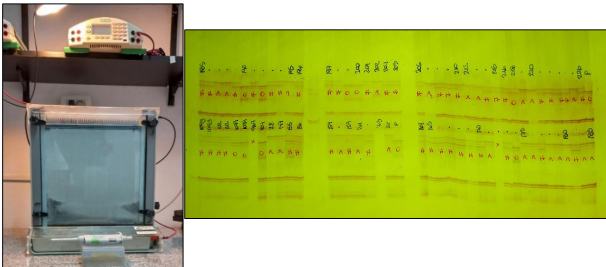
Figura 13: Visualización de marcadores moleculares de tipo SSR. Cuba de electroforesis conectada a la fuente de energía (izq). Gel de poliacrilamida desnaturalizante 5% teñido con nitrato de plata (der).
