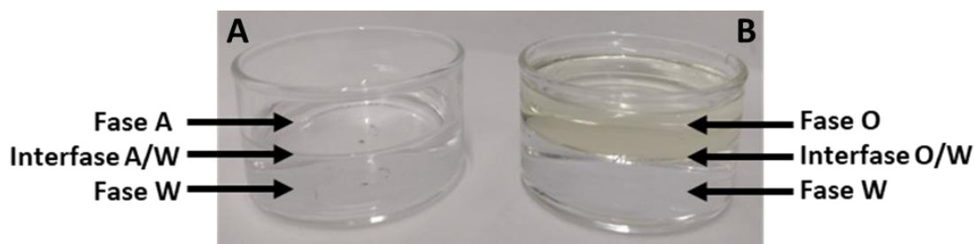
Figura III.2.6. Aspecto de las cápsulas de medición conteniendo: (A) la solución equilibrada de Q sobre la que se determinó la presión superficial (A/W) y (B) sistema sobre el que se midió la presión interfacial (O/W).
