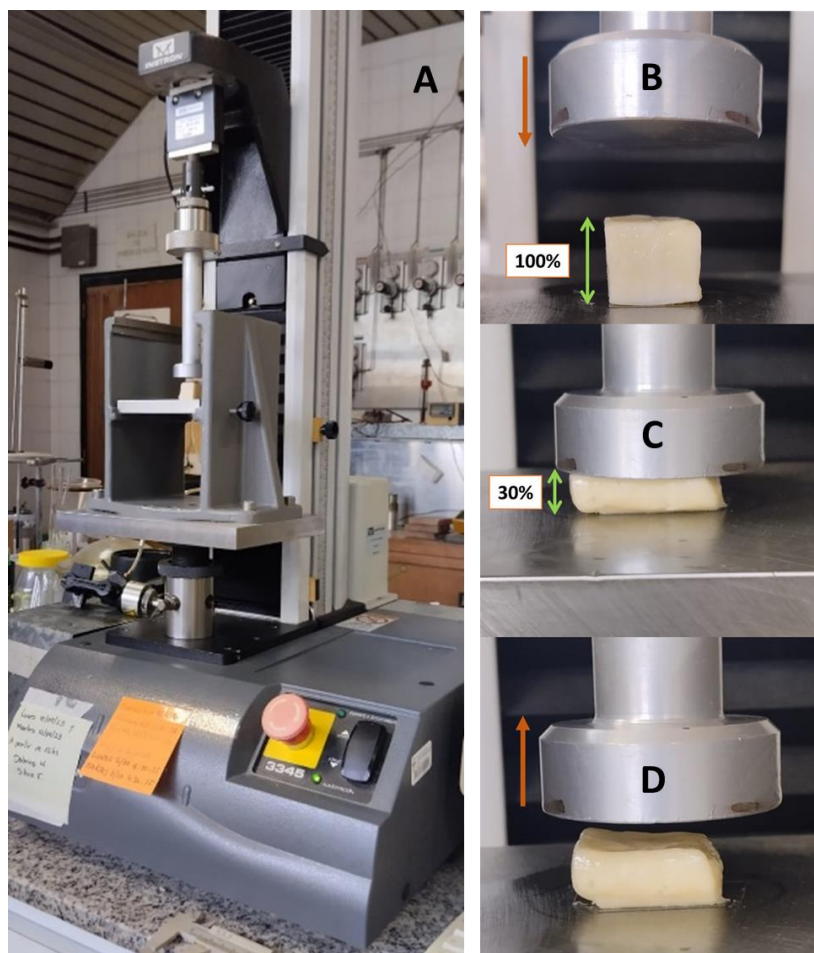
Figura IV.2.10. A Máquina universal de testeo Instron 2519-103; B, C y D etapas de la primera compresión y descompresión de muestra de queso.
