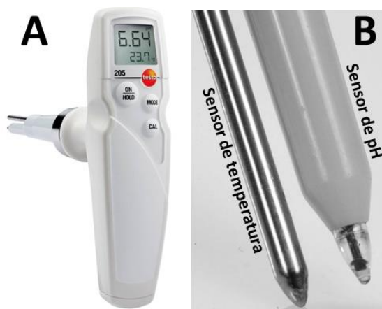
Figura IV.2.4. A Fotografía de pHmetro para sólidos, B detalle de los sensores de pH y de temperatura
