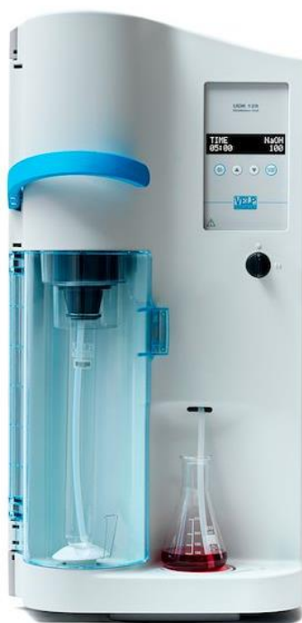
Figura IV.2.6. Fotografía de equipo semiautomático Kjeldahl UDK 129 Distillation Unit.
