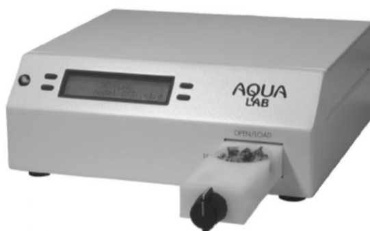
Figura IV.2.5. Fotografía de higrómetro de punto de rocío Aqualab 3TE.
