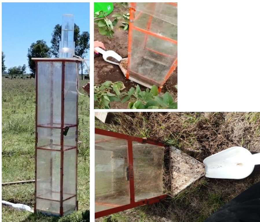
FIGURA 5-2. DISPOSITIVO QUE UTILIZAMOS EN CAMPO PARA OBTENER EL AGUA DE ESCORRENTIA SUPERFICIAL.
