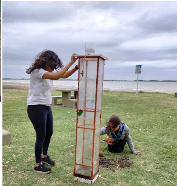
FIGURA 5-4. A LA IZQUIERDA EL SEÑALADOR MARCA LA UBICACIÓN DEL SITIO DE MUESTREO EN LA ZONA URBANIZADA (35°16'23"S 59°07'36") TOMADA DEL GOOGLE EARTH Y A LA DERECHA UNA FOTO TOMADA CUANDO SE INSTALÓ EL SIMULADOR DE LLUVIA EN UNA DE LAS PARCELAS.
