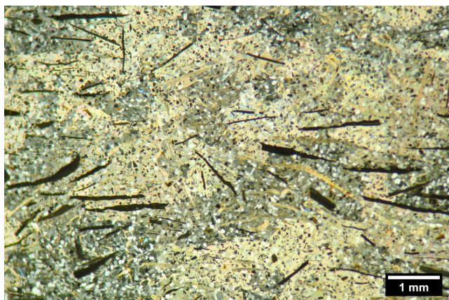
(A) Arenisca calcárea con empaquetamiento suelto, cemento carbonático poikilotópico y fábrica clasto-sostén a flotante.
