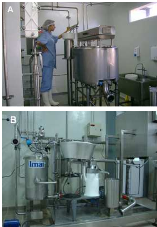
Figura 29. Tina quesera a escala planta piloto (180L) (EEA-Rafaela, provincia de Santa Fe) (A). Módulo tanque para la recepción de la leche, desnatadora ELECREM® y pasteurizador de placas REDA® (B).
