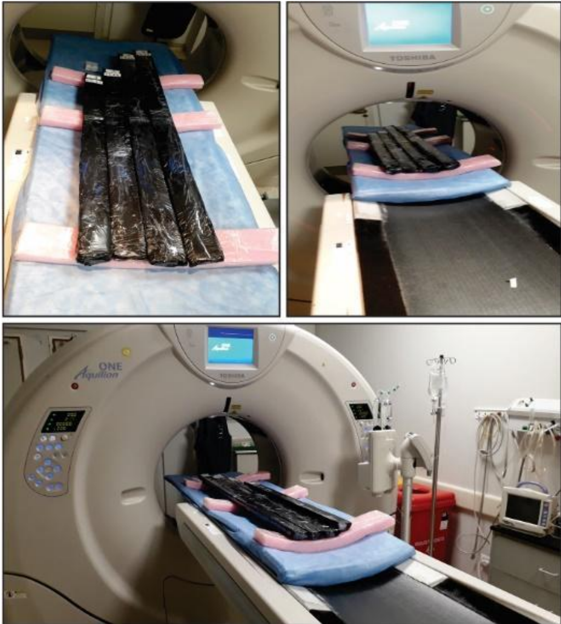
Figura 2.5: Imágenes ilustrativas de la preparación de los testigos para la tomografía computada.
