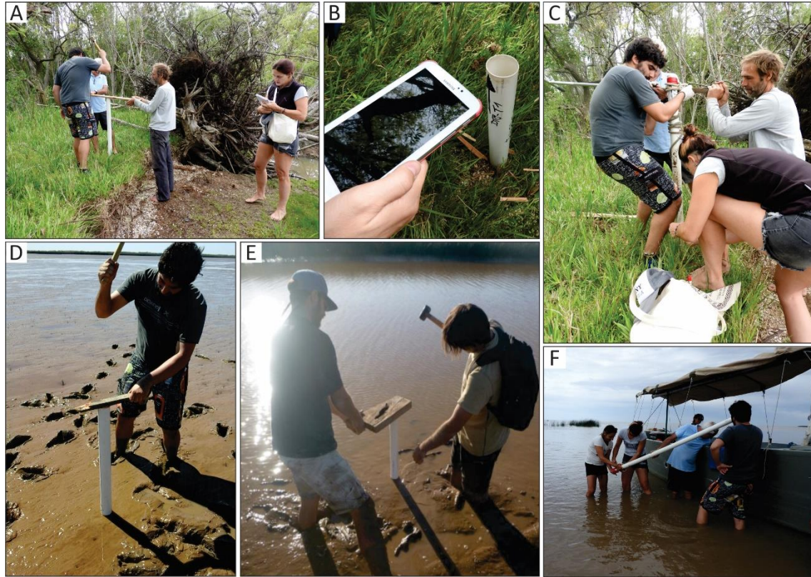
Figura 2.1: Trabajos de campo. A: Hincado de tubo PVC en barra vegetada. B: Medición de coordenadas y excedente exterior y profundidad interior del sedimento C: Maniobras de tracción para extracción de testigo. D, E: Hincado de tubo PVC en planicie de marea. F: Extracción testigo en ambiente subacuático.
