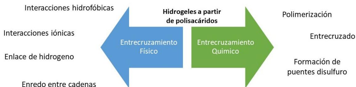
Figura 3.5. Entrecruzamiento físico y químico en la formación de hidrogeles a base de polisacáridos.
