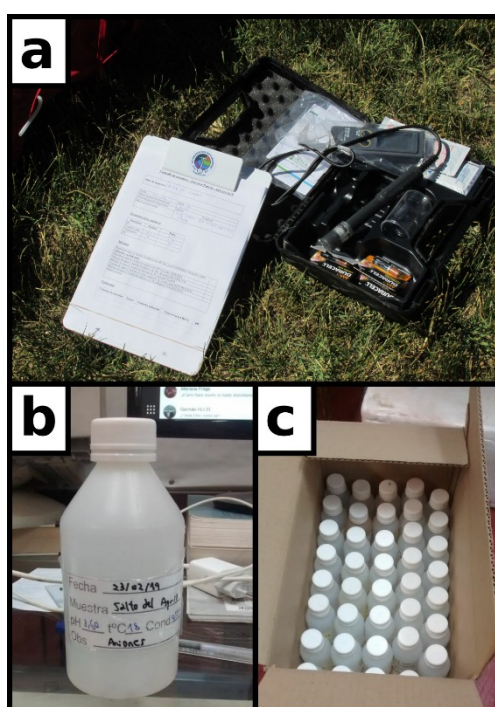
Figura 4.1: a) Equipo multiparamétrico para análisis de parámetros fisicoquímicos; b) Botella plástica de 250 ml para análisis de aniones mayoritarios; c) Conjunto de botellas plásticas de 100 ml para análisis de cationes mayoritarios.
