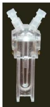
Figura 3.3: Celda utilizada para la medición del potencial Z en el equipo Zetasizer Nano-Zs.
