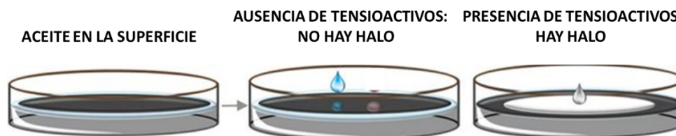
Figura 1.7: Esquema del ensayo del halo adaptado da Silva et al. (2021b)
