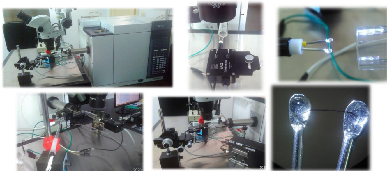
Figura 14. Sistema de detección electroantenográfica (DEA Syntech, Alemania), acoplado a un cromatógrafo de gases (CG, Agilent 7890B, Agilent Technologies, Inc., EE.UU.) con un detector de ionización de llama (FID, en inglés). Se muestran imágenes del dispositivo y de antenas de S. noctilio “montadas” para registrar la respuesta antenal frente a los volátiles colectados de las distintas fuentes evaluadas.
