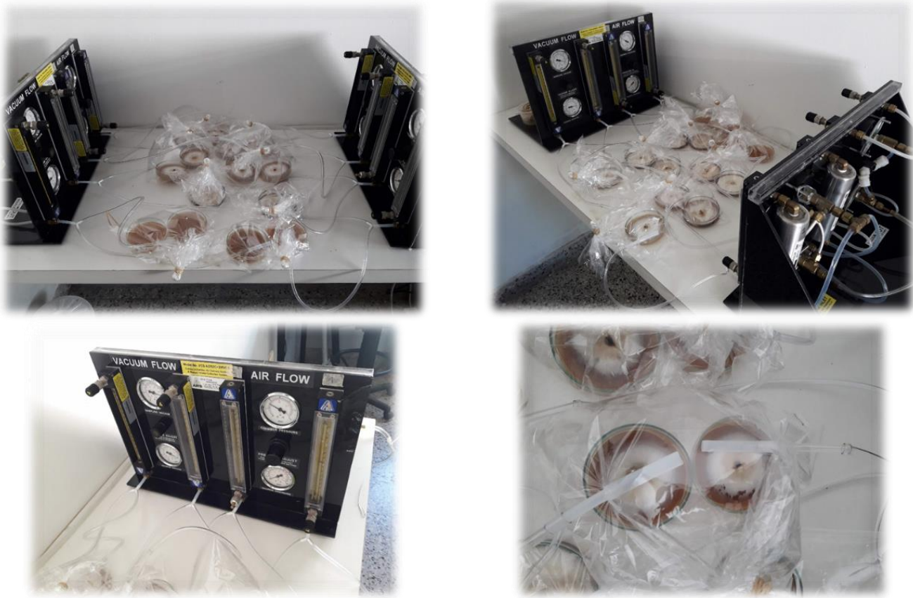
Figura 13. Sistemas de colecta de volátiles de 8 brazos. Las colectas se realizaron mediante un equipo con el cual es posible concentrar y retener los compuestos volátiles emitidos por una fuente a través de filtros (polímeros porosos) y bombas diseñados para tal fin. Mediante una primera bomba (AIR FLOW), se emitió un flujo de aire purificado (carbón activado), el cual atravesaba una cámara (en este caso se trató de una adaptación elaborada con bolsas de nylon comerciales (bosas para horno)), donde se encontraba la fuente emisora de los volátiles. Luego se extrajo con una bomba de succión (VACUUM FLOW) a una velocidad constante de 0,5 litros min -1 . El aire que salió del receptor pasó a través de una matriz adsorbente de polímero poroso (30 mg de HayeSepQ ® ) donde se recolectaron los volátiles. Las colectas se realizaron en oscuridad y a una temperatura constante de 24°.
