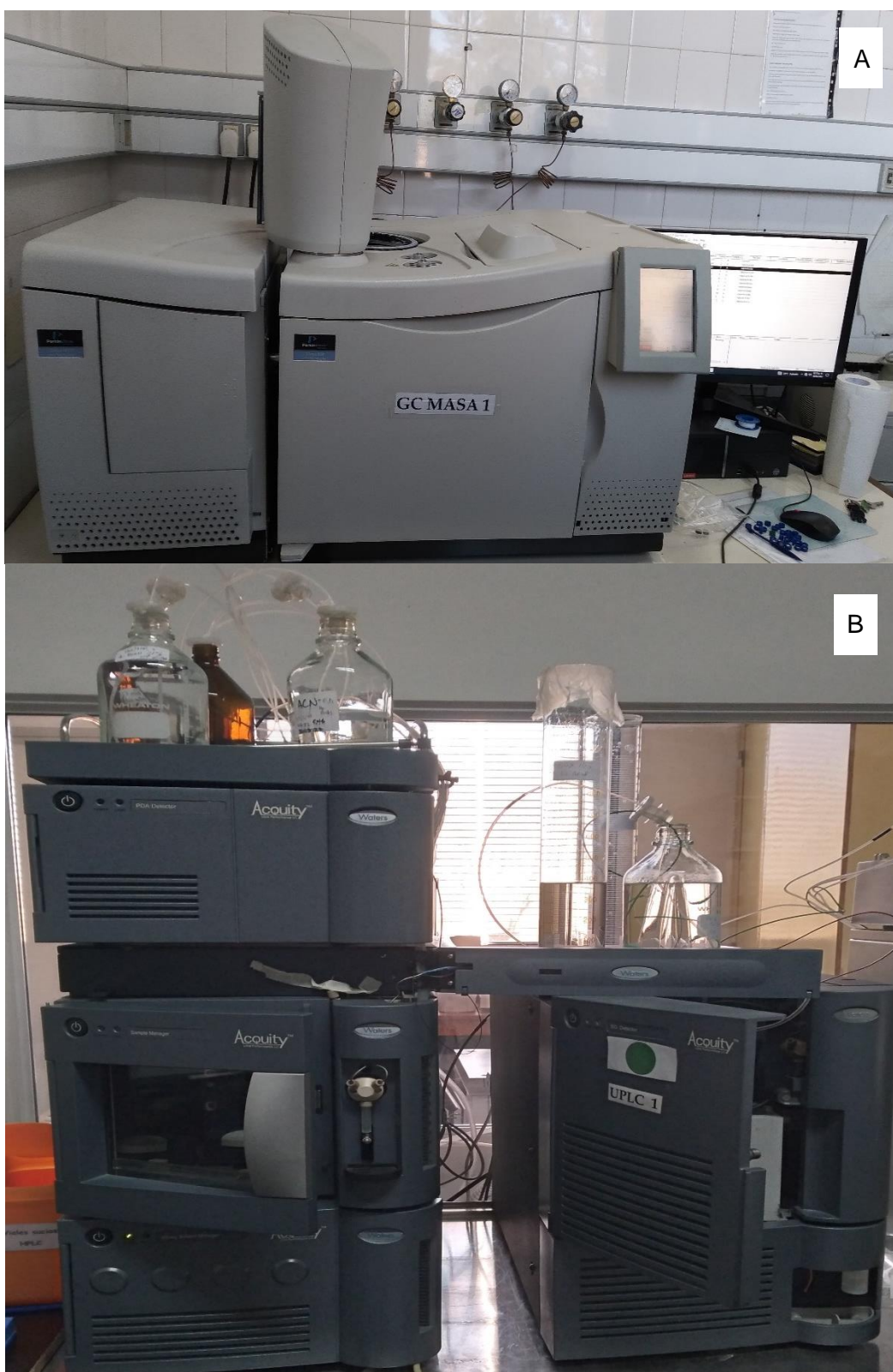
Figura 2.11. A) Cromatógrafo de gases asociado a espectrómetro de masas (GC-MS) Perkin Elmer, modelo Clarus 600. B) Cromatógrafo de líquidos asociado a espectrómetro de masas (LC-MS), Waters Acuity UPLC-SQD. Crédito fotográfico: grupo INSSOC.
