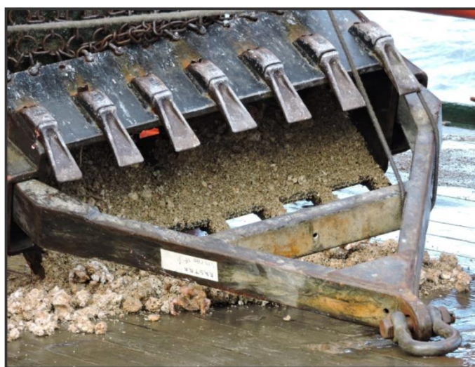
Fig. 26: Draga de arrastre utilizada en el BOA. Notar la variabilidad en los tamaños de sedimento recolectado, junto a la presencia de material orgánico (conchillas).
