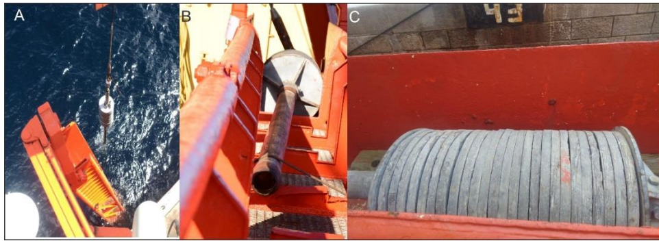
Fig. 23: A) Equipo completo de gravity corer en el momento en que ingresa en el agua. B) Equipo gravity corer con una sola pipa colocada. C) Detalle del cabezal con el lastre correspondiente a pesas de 50 kg.
