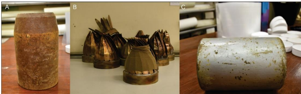
Fig. 24: A) Boquilla de corte. Observar su punta más filosa. B) Válvulas de retención. Esta se coloca dentro de la boquilla de corte. C) Cupla utilizada para unir las pipas en caso de que las condiciones sean favorables, expandiendo el rango de obtención de muestra de 3,5 m a 7 m.
