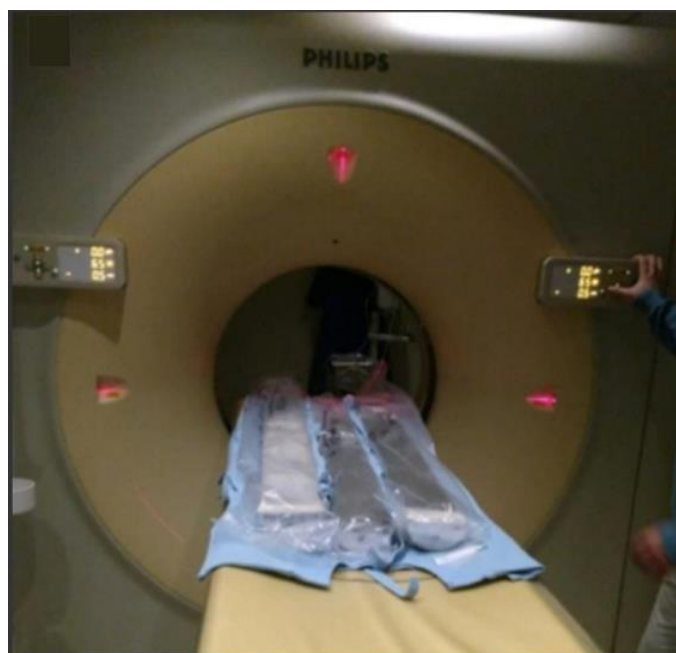
Fig. 53: Tomógrafo utilizado para el estudio de los testigos sedimentarios.
