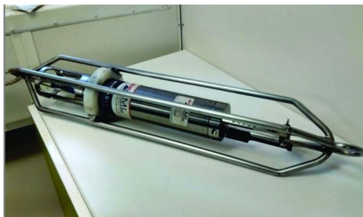
Fig. 20: Perfilador de velocidad de sonido AML Mino-x SV 6000 dBar del Buque Austral.
