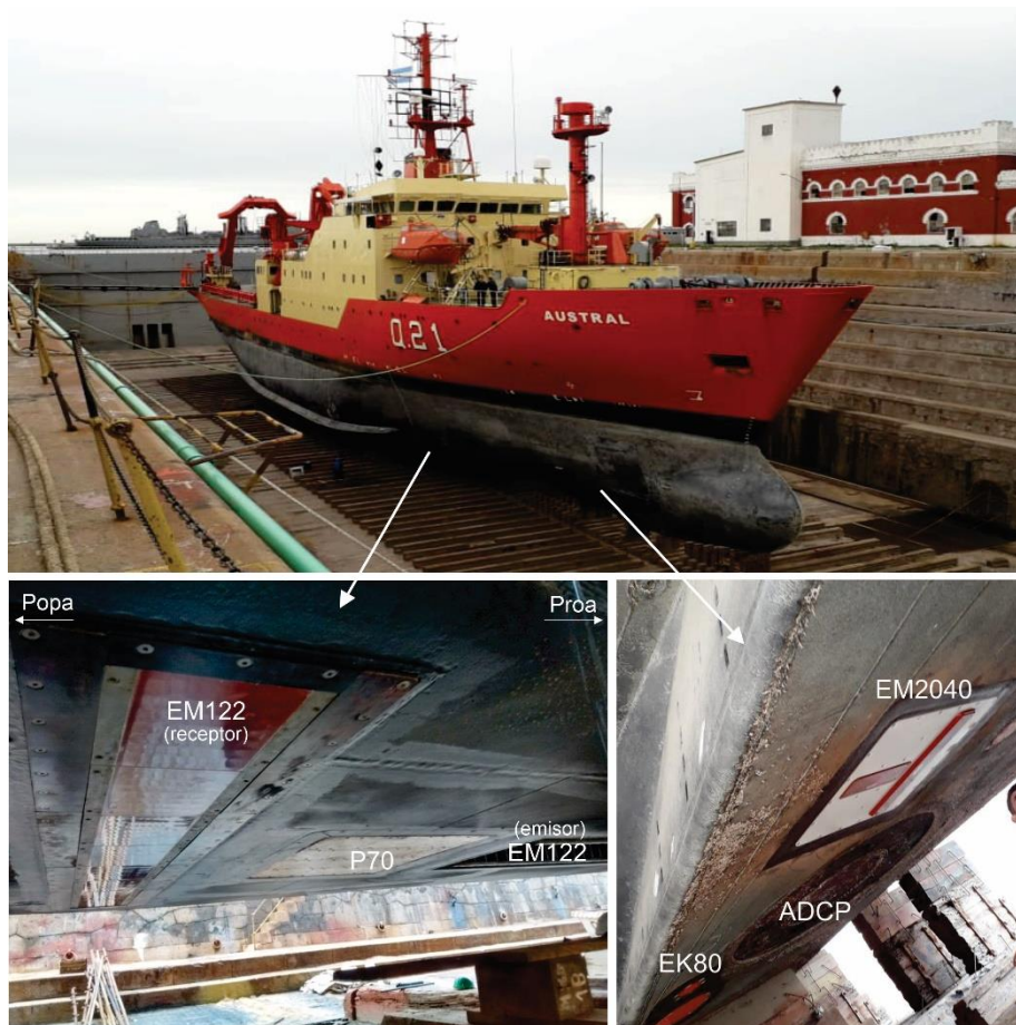
Fig. 15: Buque Oceanográfico Austral con los equipos acústicos instalados en su casco. EM112: Equipo de batimetría multihaz, P70: Equipo para la adquisición de sísmica de alta resolución. ADCP: Equipo para la medición de corrientes oceánicas. EM2040 y EK80 son otros equipos que posee el buque los cuales fueron instalados en el 2018 (posterior a
