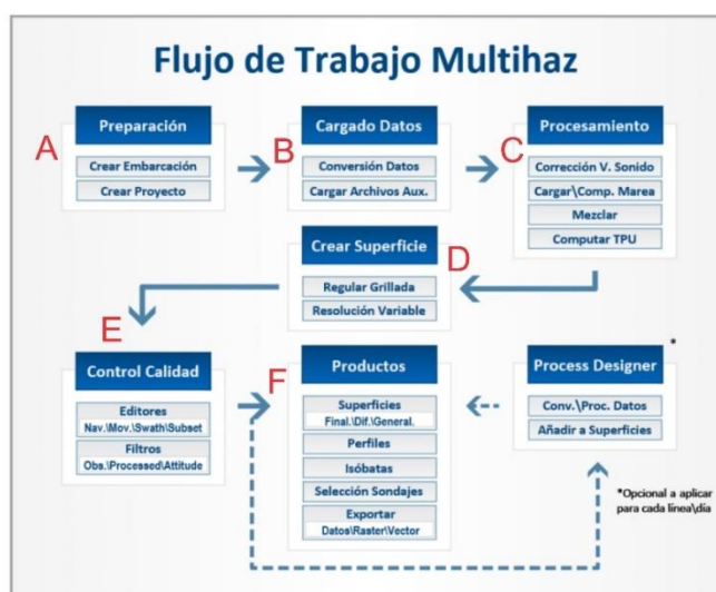
Fig. 45: Flujo de trabajo para el procesamiento de la batimetría multihaz. Modificado del manual de entrenamiento Teledyne Caris (v. 10.4).
