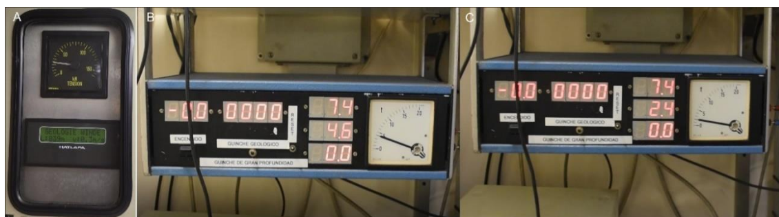
Fig. 25: Tensiómetros en el laboratorio geológico del BOA. A) Tensiómetro 1. B) Tensiómetro 2 durante el lascado con una tensión de 4,6. C) Tensiómetro 2 al momento de tocar fondo. Observar como la tensión disminuye en ese momento hasta 2,4.
