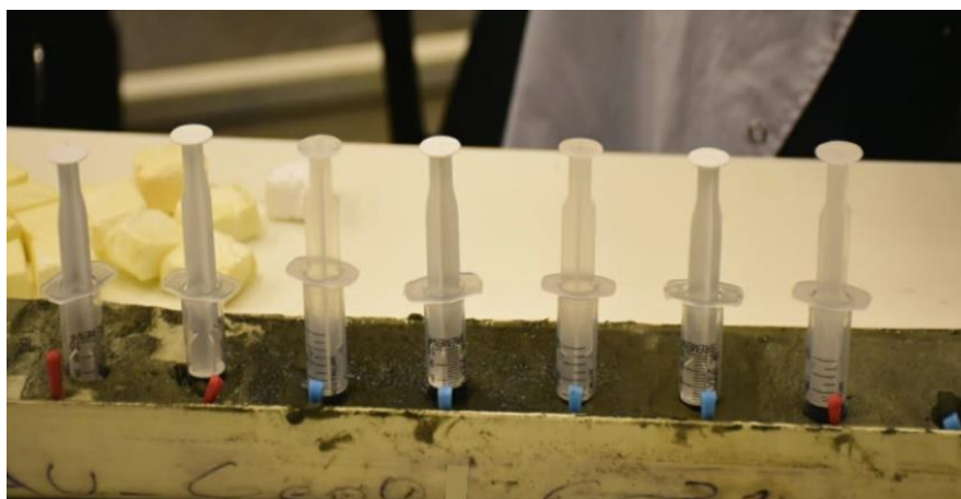
Fig. 52: Muestreo de sedimento con jeringa.
