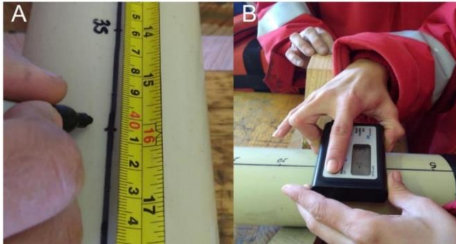
Fig. 54: A) Marcas cada 5 cm sobre testigo cerrado de sedimento. B) Mediciones en los intervalos de 5 cm con el susceptibilímetro de mano.
