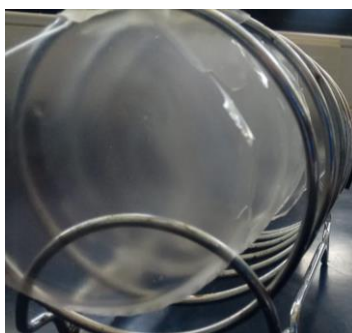
Figura 3.3 – Distribución homogénea del expeller de soja sonicado (SSE) en películas a base de almidón de mandioca con 0.4 g de SSE (Exp4).
