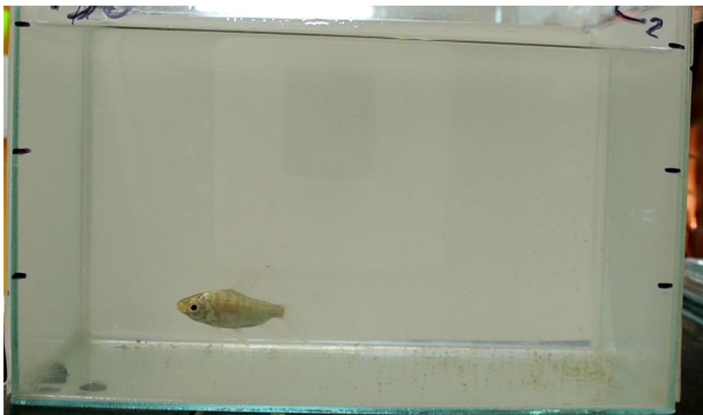
Figura 42- Vista frontal de un acuario experimental. En los laterales es posible ver las marcas que definen los estratos del acuario (inferior, medio y superior).
