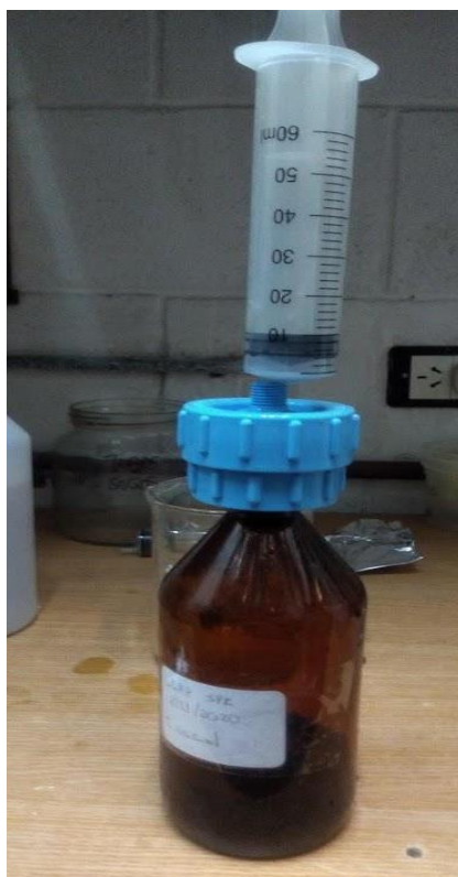
Figura 16- Sistema de filtración de agua con portafiltro con filtro de nylon y jeringa de 60 ml.
