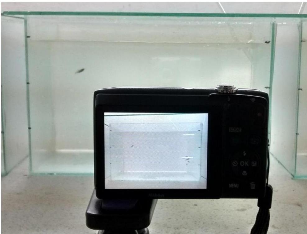
Figura 41- Disposición de la cámara para la filmación frontal de los acuarios experimentales.
