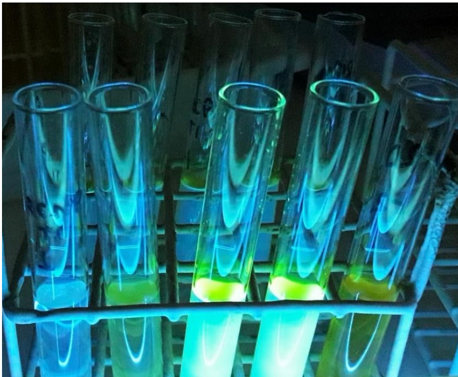
Fig. 10: Análisis de bacteria coliformes totales (CT) y fecales (CF). De izquierda a derecha: un tubo negativo para CT y CF, un tubo positivo para CT, dos tubos positivos para CT y CF, y un tubo positivo para CT.
