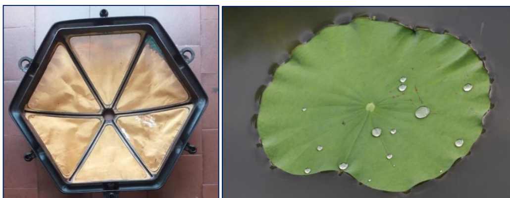
Figura 3.41. Dispositivo Y-RUPE desarrollado y patentado por Y-TEC para el uso de membranas superhidrofóbicas en separación de petróleo-agua. El diseño está bioinspirado en las hojas del irupé.
