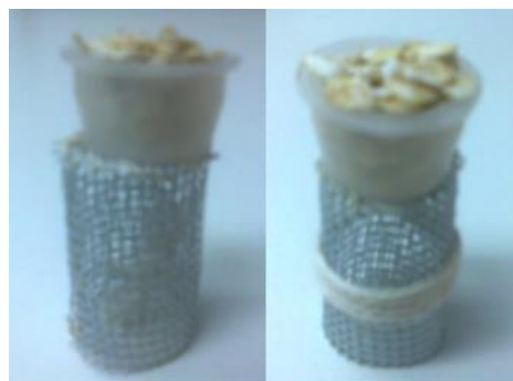
Fig.4. Disposición de los hilos en las jaulas según el ensayo. Izquierda: claves volátiles. Derecha: claves de contacto.
