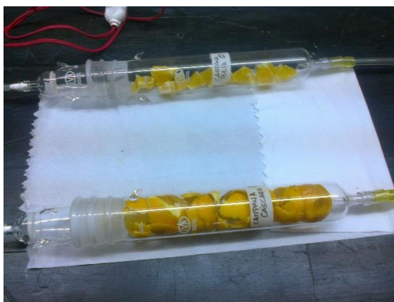
Fig. 3. Cámaras de vidrio con las diferentes porciones de naranja para la colecta de volátiles.
