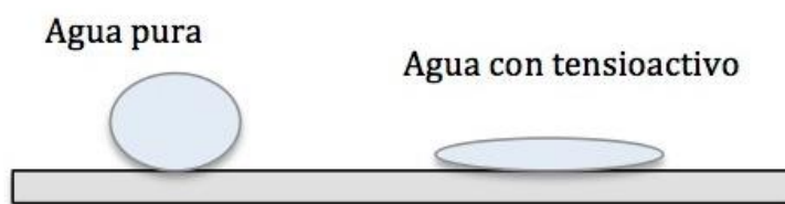
Figura III.4 Efecto de los tensoactivos Efecto de un tensoactivo en la forma de una gota de agua en contacto con una superficie hidrófoba
