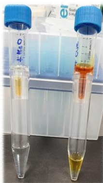
Figura III.9 Unidades filtrantes para separar y purificar las NP-PLGA-CUR del PA no encapsulado NP-PLGA-CUR (izquierda) y CUR libre (derecha)
