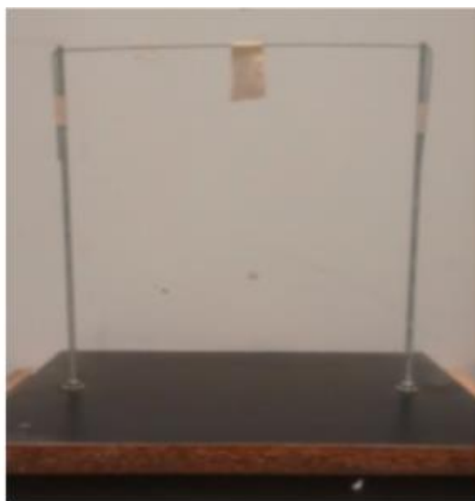
Figura II.13. Dispositivo experimental con el que se realizó el ensayo de suspensión de la cola.
