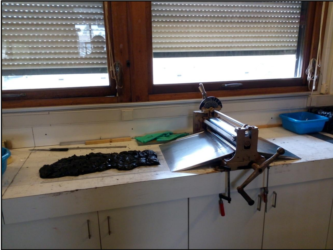
Figura AP3.2. Aparato similar a la “Pastalinda” usado para estirar y adelgazar la silicona.
