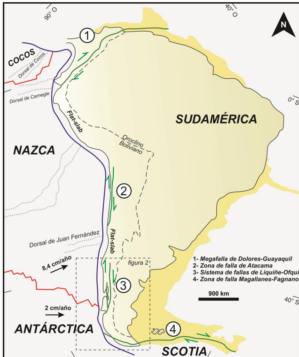
Figura 6.1. Configuración de la zona de subducción, delineada por alternancia de segmentos de flat-slab con segmentos de fallas de deslizamiento de rumbo paralelas a la trinchera (líneas verdes). Líneas rojas= dorsales sísmicas. Líneas azules= trinchera.
