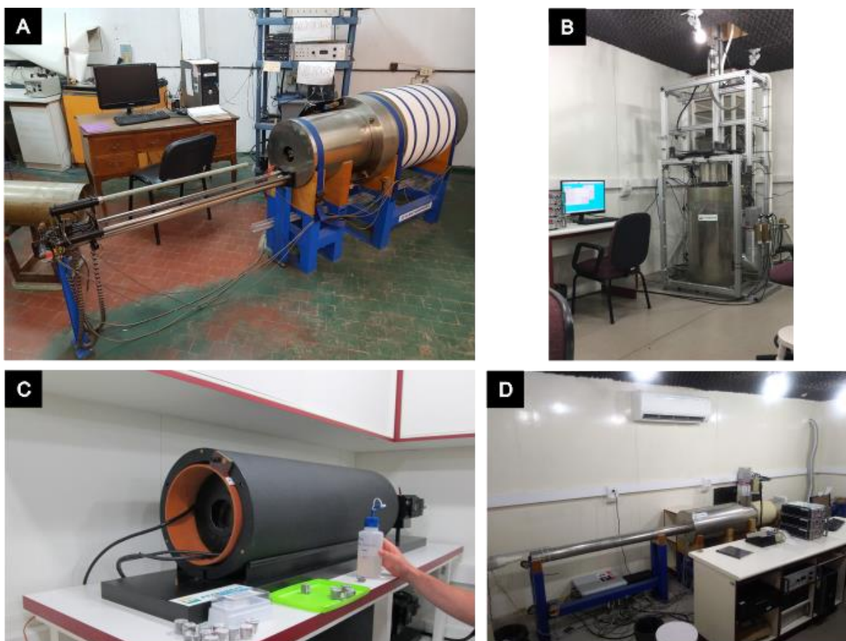
Fig. 5.2: Equipos utilizados en el procesamiento de los especímenes. A) Magnetómetro criogénico DC-SQUID 2G, IGEBA-CONICET, B) Magnetómetro criogénico 2G (WSGI) libre de helio y totalmente automático (sistema Rapid), IAG-USP, San Pablo. C) Horno TD48SC Schoenstedt, IAG-USP, San Pablo. D) Magnetómetro criogénico DC SQUID 2G, IAG-USP, San Pablo.
