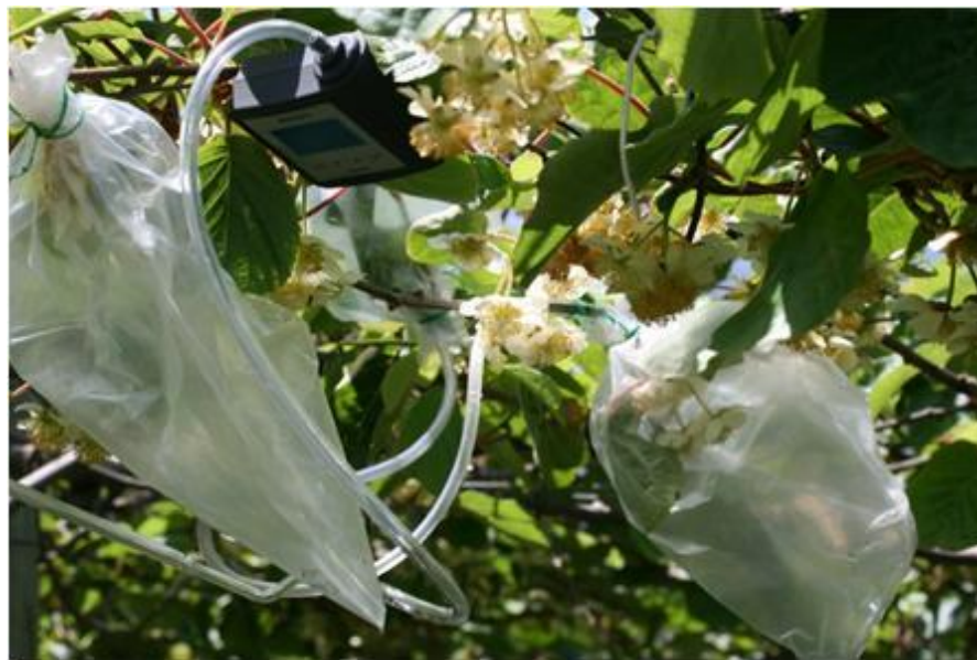
Figura 4.4. Dispositivo de colecta de volátiles in vivo de plantas de kiwi. El dispositivo está formado por una bomba succionadora de aire conectada mediante una división de vidrio a tres trampas de colecta sujetas cada una a una rama portando flores recién abiertas. Crédito fotográfico: INSSOC.
