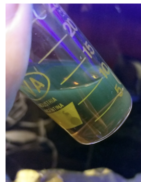
B Suspensión concentrada de GQD obtenida tras su síntesis bajo iluminación de luz UV.
