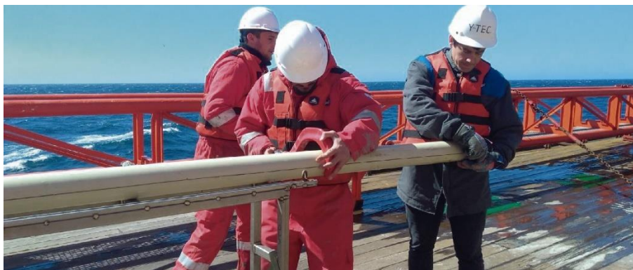
Fig. 28. Maniobra de corte de portatestigo en la cubierta del BOA.
