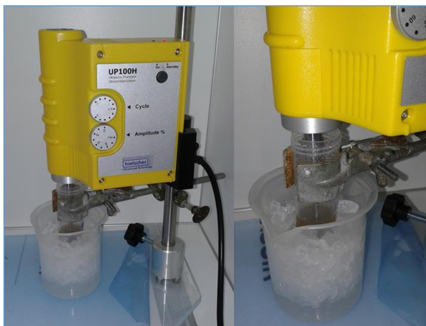
Figura 1.12. Equipo empleado para realizar extracción asistida por ultrasonido (Hielscher Ultra Sound Technology modelo UP100H).
