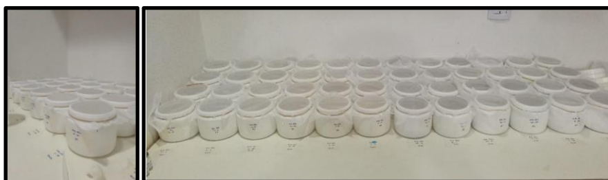
Figura 5.2. Tarros Experimentales (TE), utilizados en la experiencia. Puede observarse la tela voile sujeta por una banda elástica, cubriendo cada TE.
