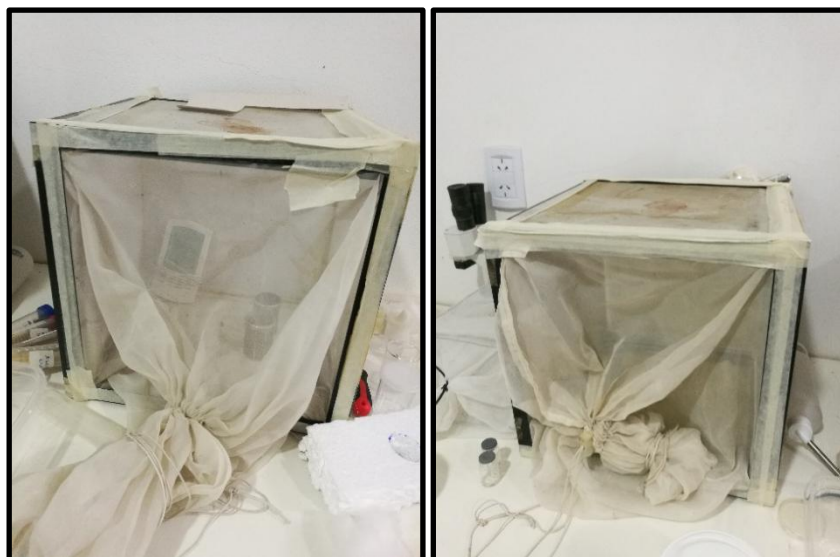
Figura 5.1. Jaulas de cría de mosquitos. Las mismas constan de un cubo con vértices de aluminio dos lados de cartón rígidos, dos con acetato transparente y dos con tela voile , la cual una consta de una manga con doble seguridad de cierre lo que permite la entrada a la caja de cría.
