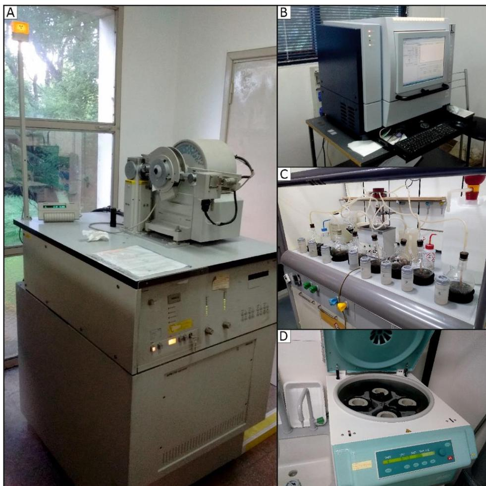
**Figura 3.2:** A) Difractómetro *Phillip X-Pert PW3710* (CETMIC) utilizado para realizar los barridos de mineralogía total. B) Difractómetro *Bruker D2 Phaser* (CETMIC) empleado para estudiar la mineralogía de arcillas. C) En proceso de remoción del carbonato bajo agitación constante (UNIL), con posterior dispersión en baño de ultrasonido para obtener la fracción <2  $\mu\text{m}$ . D) Centrífuga utilizada para lavar las soluciones y obtener la fracción <2  $\mu\text{m}$  (UNIL).
