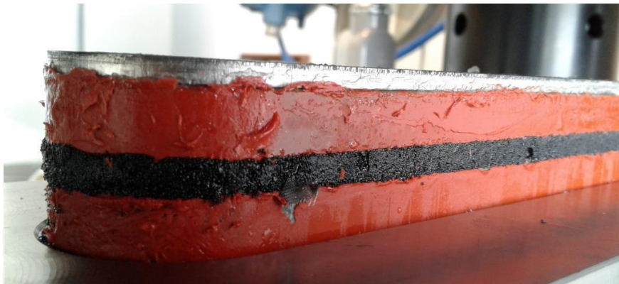
Figura 5.2. Pack de proppant antes del ensayo de Conductividad (Ensayo y foto realizados en YTEC)
