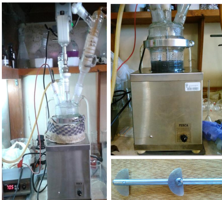
Figura 2.5. Fotografía del reactor y varilla agitadora de doble paleta utilizados en la reacción en suspensión.
