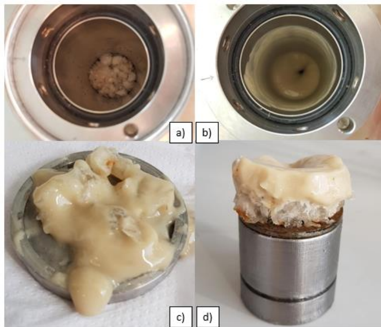
Figura 4.18. Fotos antes y después del ensayo de obturación en celda HPHT. a) Sistema PADSi (4 %) + escamas (2%), b) adición de lodo, d) malla con hidrogel y lodo, c) soporte, slot y hidrogel con lodo.
