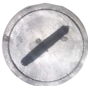
Figura 5.3. Imagen del disco con ranura de 6 mm utilizado en la celda de filtrado.
