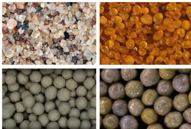
Figura 2.3. Imágenes de cuatro tipos de agentes de sostén, a) arenas naturales, b) arenas resinadas, c) cerámicos, d) cerámicos recubiertos. 8
