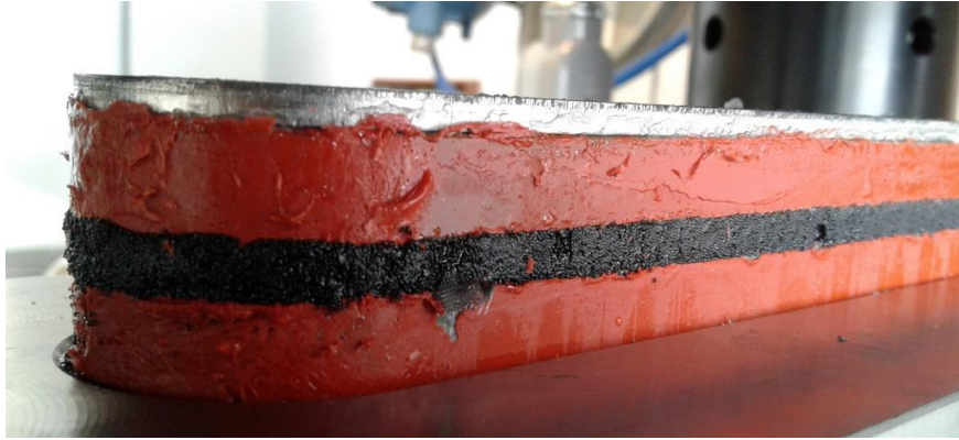
Figura 2.12. Empaquetado (pack) de AGs antes del ensayo de conductividad
