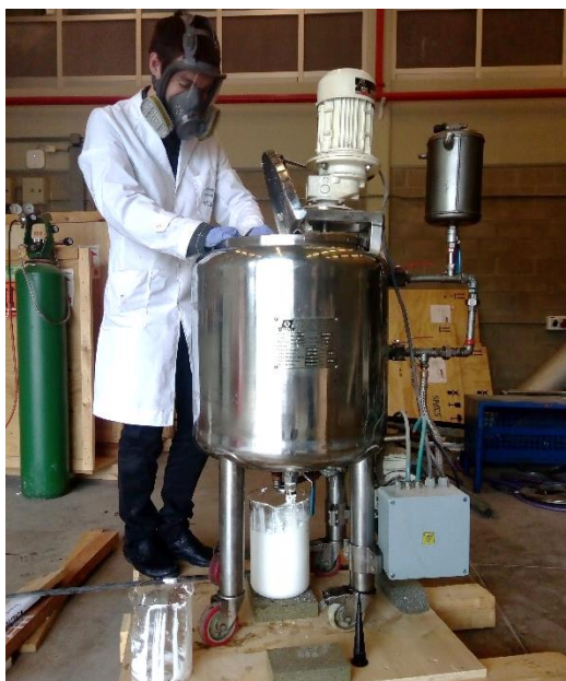
Figura 4.20. Reactor para síntesis escala intermedia (YTEC)
