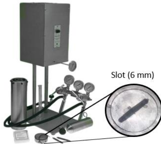
Figura 4.17 Componentes de una celda de filtrado HPHT y slot con una ranura central de 6 mm.
