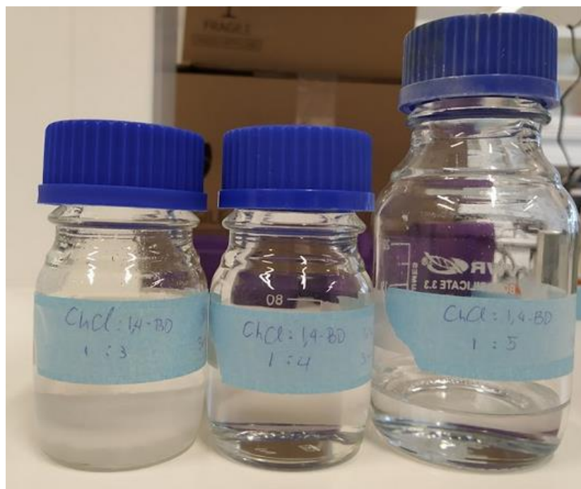
Figura 5.5. Detalle de los DES preparados tras ser almacenados 24 hs. Observar el precipitado blanco de ChCl en la botella correspondiente al DES con relación 1:3 (izquierda), es decir, aquel con mayor proporción de ChCl.
