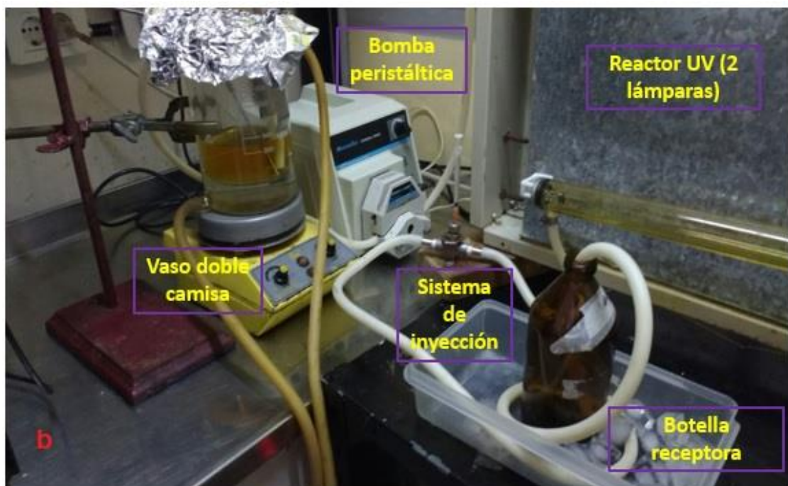
Figura 3.3.a, b. Fotografías del reactor UV-C adaptado para la determinación de la DTR y las experiencias de biosimetría.
